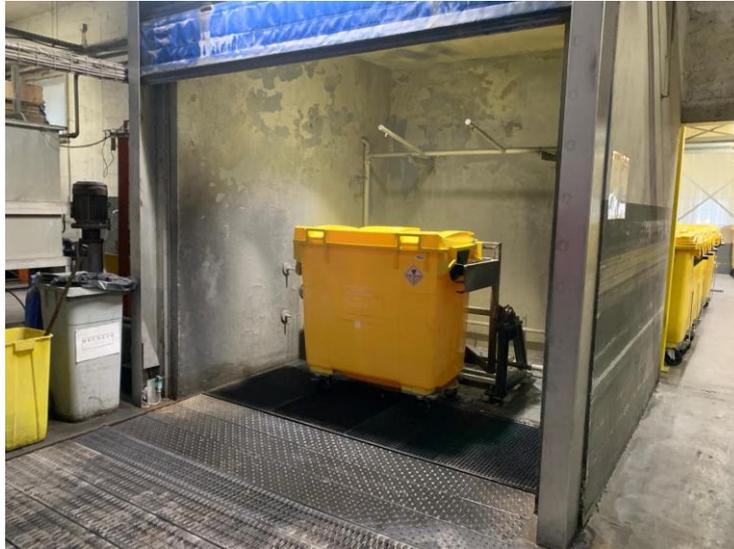
Figure 15 Cabine de lavage automatique (Observation Usine d'incinération 29 février 2024)
